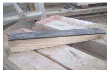
Paveikslas. Nr.3 Sandėliuojamų sienų įtvirtinimas. Atkreipti dėmesį, kad pleištai padengti netepančia, vandens neįgeriančia medžiaga!
